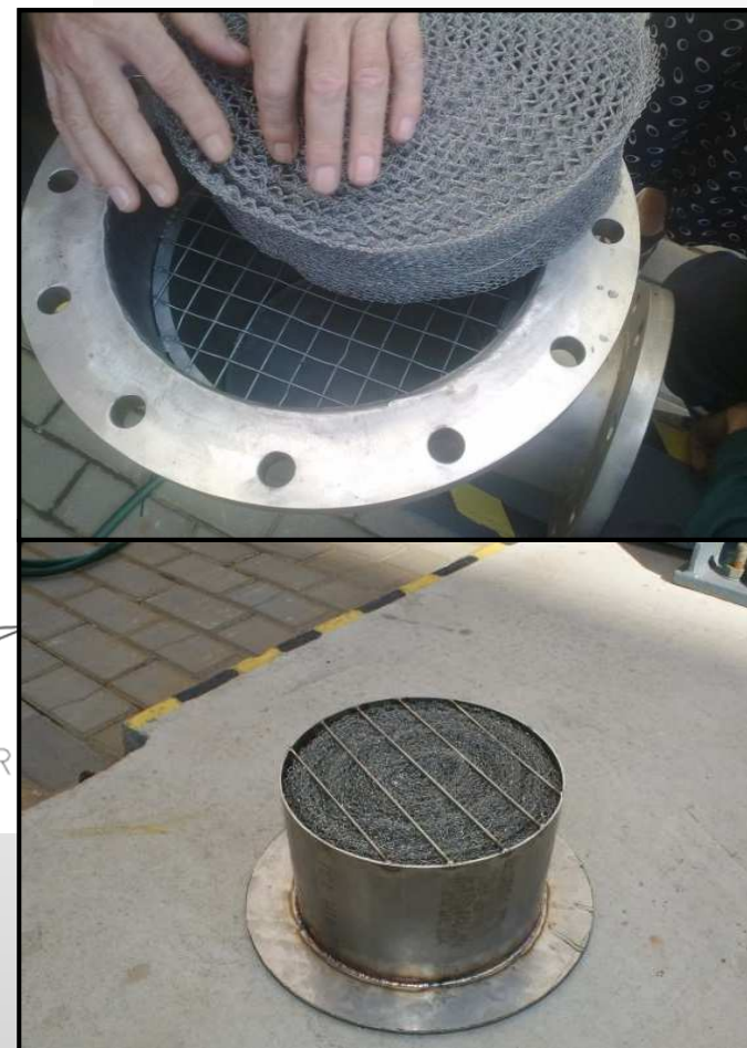
Rysunek 12: Schemat części odemglającej wraz z separatorem kropel w skruberze K-100; (rysunek lewy – skruber ze standardowym demisterem; rysunek prawy – skruber z dodatkowym demisterem)
