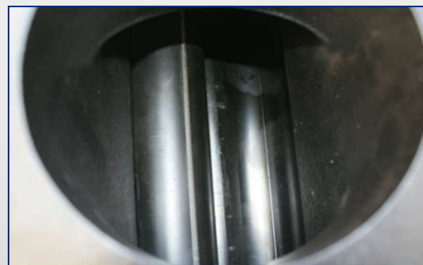
Rysunek 15: Wirniki stopnia sprężania dmuchawy po remoncie
