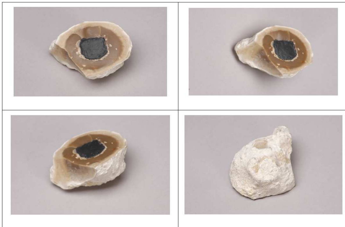
Rys. 5. Niedopał powstały w żużlu.
