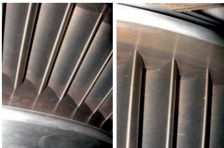
Fot. 8. Zmodernizowane przez TurboCare tarcze kierownicze części WP turbozespołu typu 13K215, wykonane z użyciem technologii spawania wiązką elektronów
