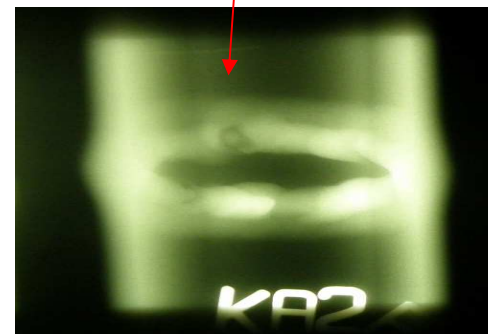
Zdjęcie 2 - Wskazanie niezgodności w grani spoiny wykryte metodami UT, RT i makroskopową
