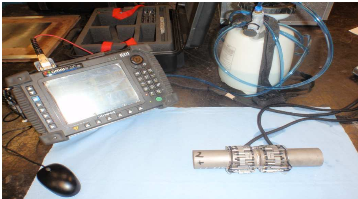
Zdjęcie nr 1. Systemu do badań UT z zastosowaniem skanera Cobra
