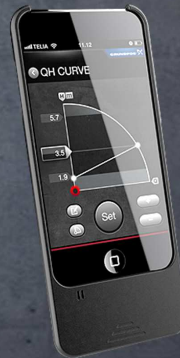
Grundfos GO – mobilny interfejs do sterowanie pompą
