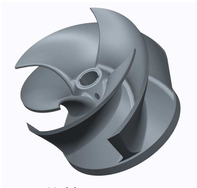
Model geometryczny wirnika pompy 180D40
