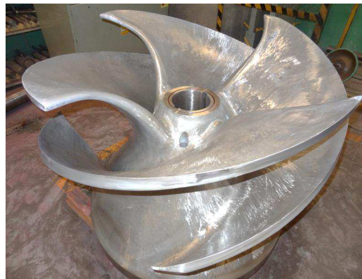
Wykonany zmodernizowany wirnik pompy 180D40
