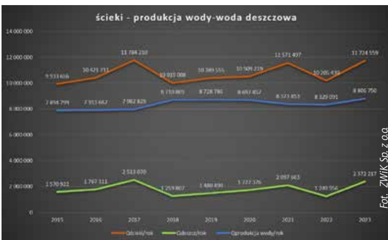
RYS. 1 Doływ ścieków i wód przypadkowych na oczyszczalnię w latach 2015-2023
